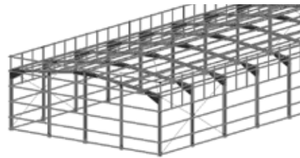
-Com Platibanda - Fachada Vertical -With Parapet - Vertical Wall Cladding -Avec Prise - Façade Verticale -Con Platibanda - Fachada Verticale
